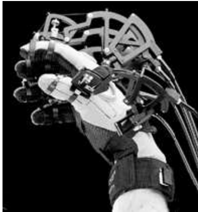
Figura 12. CyberGrasp. Un sensor que permite agarrar y sentir objetos virtuales
